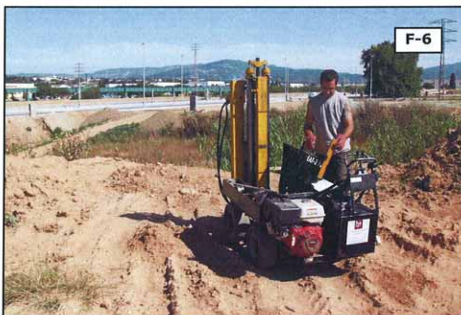
Fotografies 5 i 6: Emplaçament del penetròmetre a P-1 i P-2.
